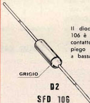
Il diodo subminiatura tutto vetro SFD 106 è un diodo al Germanio a punta di contatto di tungsteno adatto per l'impiego come rivelatore video ed audio a bassa impedenza.
