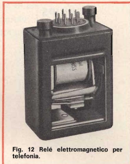
Fig. 12 Relè elettromagnetico per telefonia.
