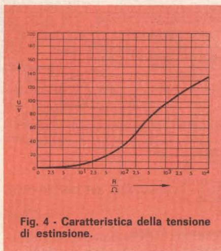
Fig. 4 - Caratteristica della tensione di estinzione.
